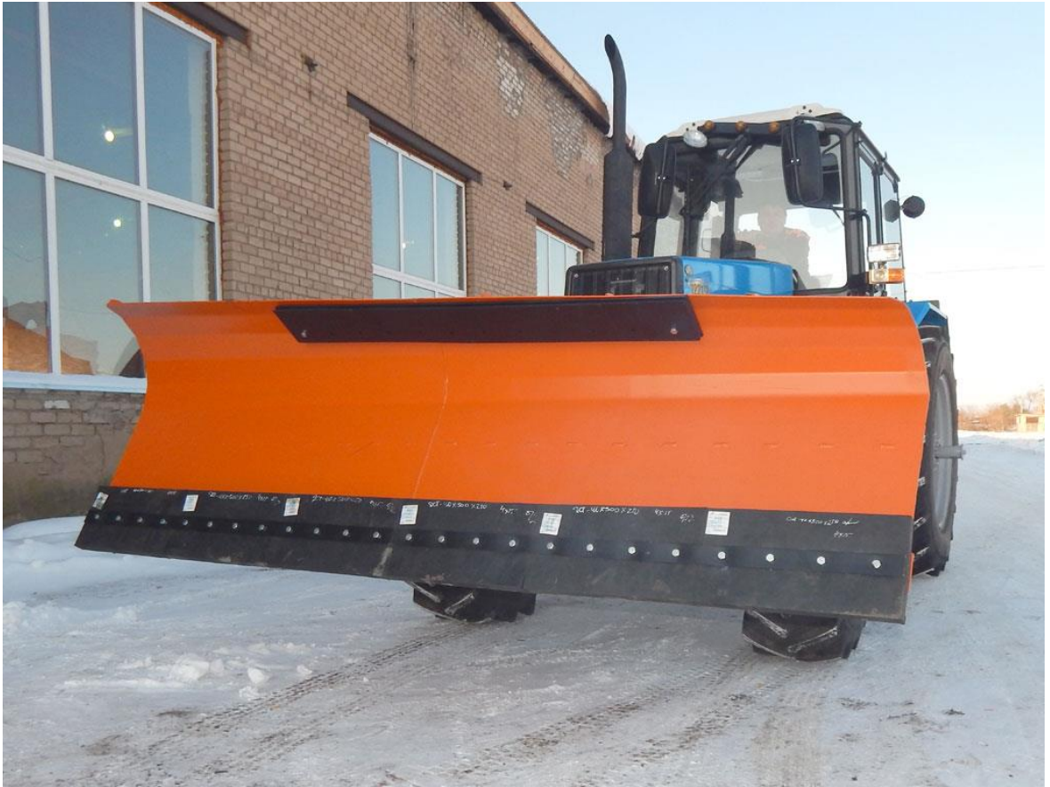
Рисунок 1.3 – Трактор МТЗ с бульдозерной навеской.
