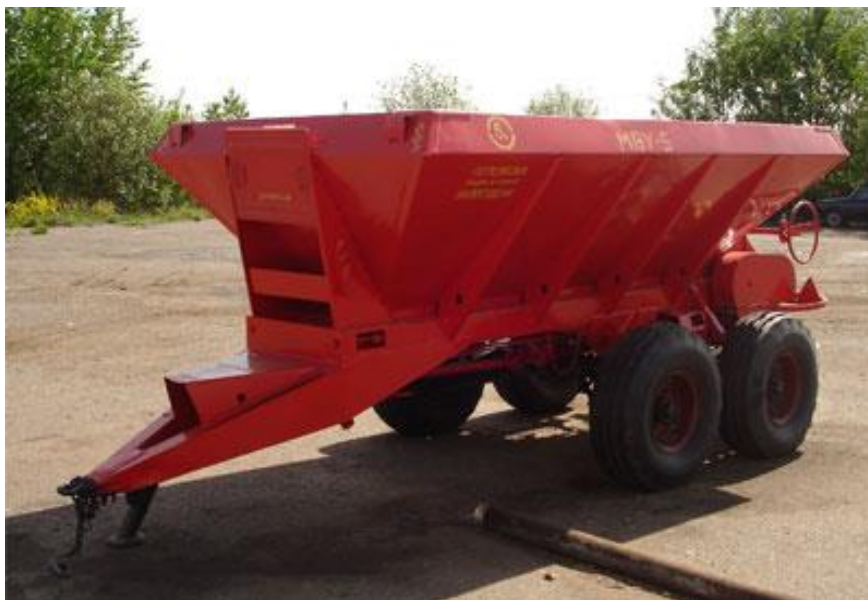
Рисунок 1.9 – Общий вид разбрасывателя РУМ-5 (МВУ-5).
