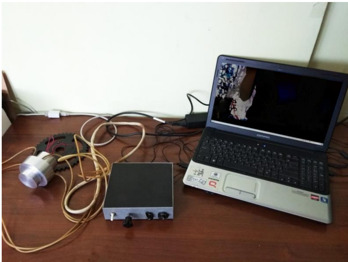
Рисунок 3.7 – Комплекс для измерения крутящего момента.
