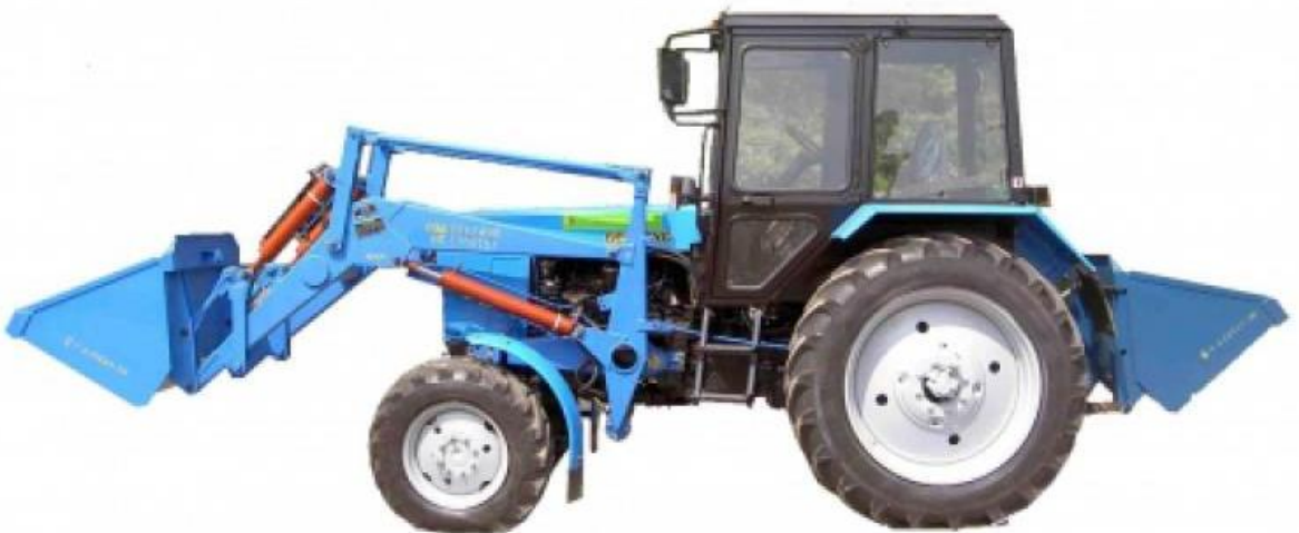
Рисунок 1.4 – Навесной погрузчик ПКУ-0,8 с ковшом на трактор.
