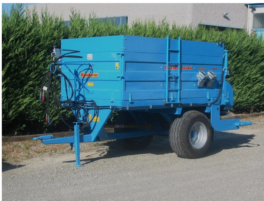
Рисунок 1.5 – Разбрасыватель органических удобрений «GL 4000».
