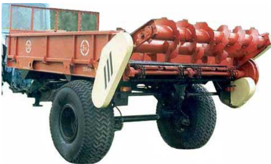
Рисунок 1.13 – Машина для внесения органических удобрений МТО-3.
